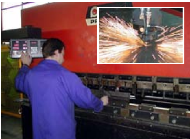
Machine de tôlerie à commande numérique. Laser pour découper les formes les plus complexes en Inox.
