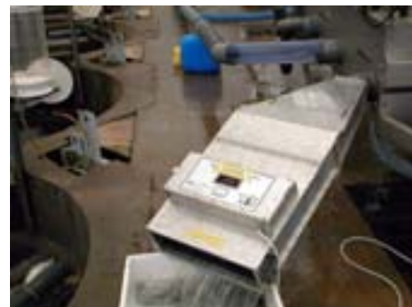
Compteur C16 avec bac de réception* en sortie de trieur Hélios 30.
