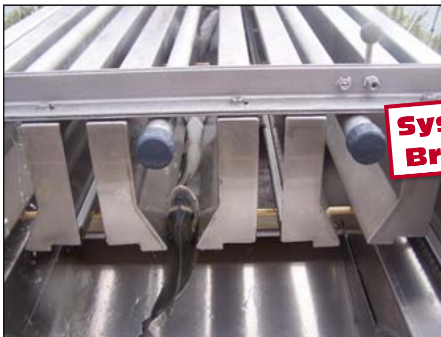
Daurades de 900g dans un trieur Helios 50. (Vue en fines canaux de triage)
