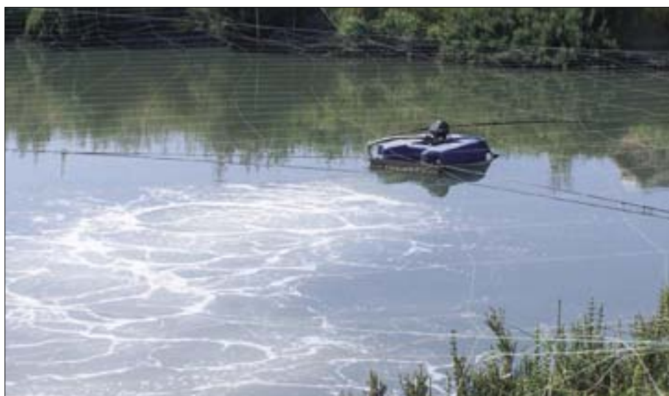
Ci-dessus : AÉROPULSE 2cv-380v, en fonctionnement sur un étang d'élevage de Daurades.
