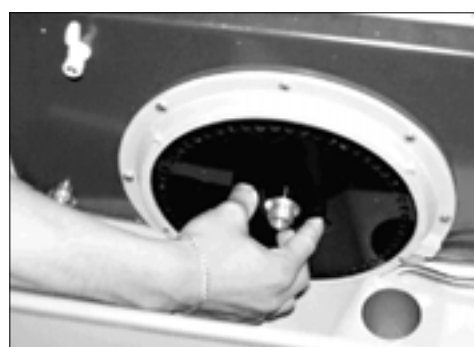
Disques de tri et capteurs opto-électroniques
