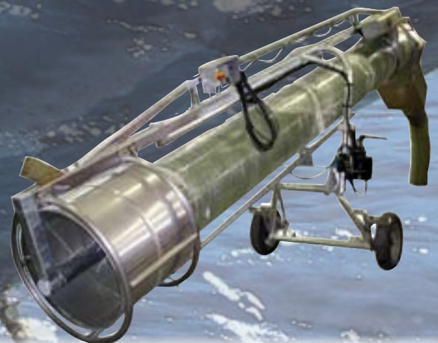
Élévateur avec tambour de pêche série 77 Ø450mm, 6,5m de long.
