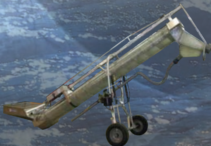
Élévateur avec trémie de chargement série 85 Ø330mm.
