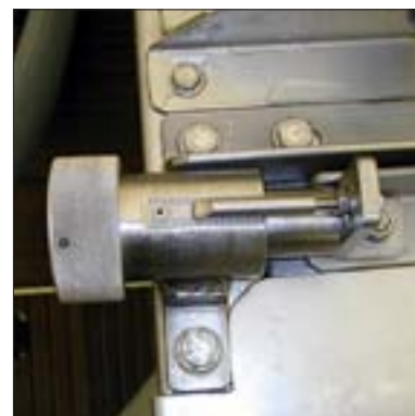
Verniero di regolazione dei canali.
