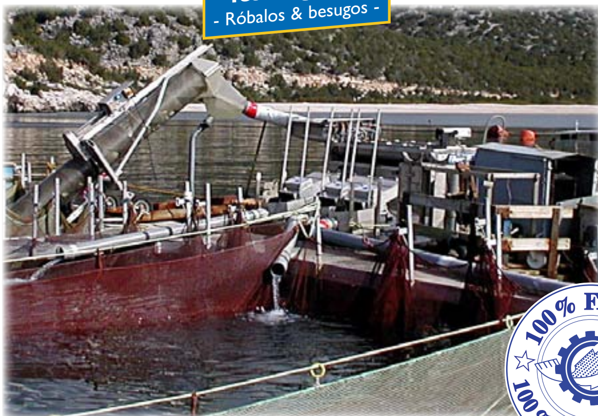
Seleccionador HELIOS 30S con contadores, alimentado por un elevador SERIE 77 ALU en un criadero de Róbalo y Besugos.
