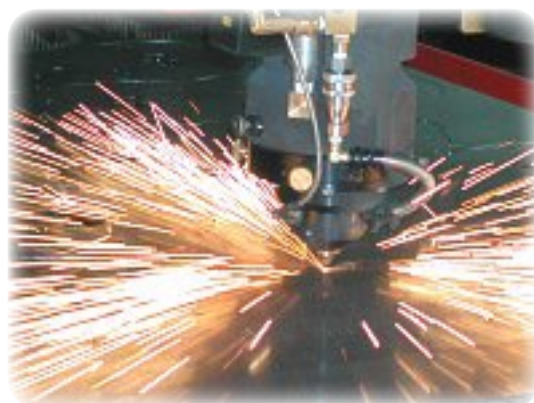
El corte láser permite cortar las formas más complejas de acero inoxidable con una precisión 3/10 mm. Todas nuestras fabricaciones se benefician de esta tecnología.
