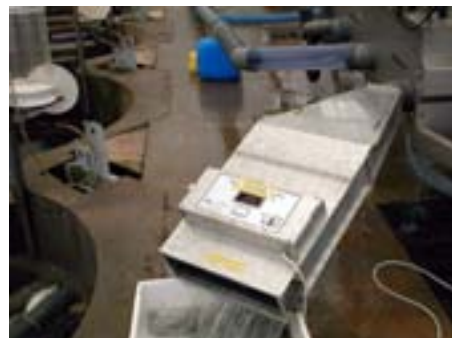
Contador C16 con depósito de recepción* a la salida del seleccionador Hélios 30.
