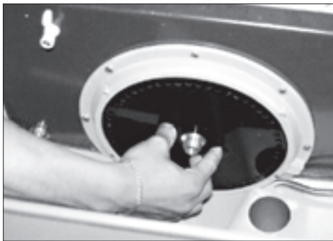
Discos de selección y sensores optoelectrónicos
